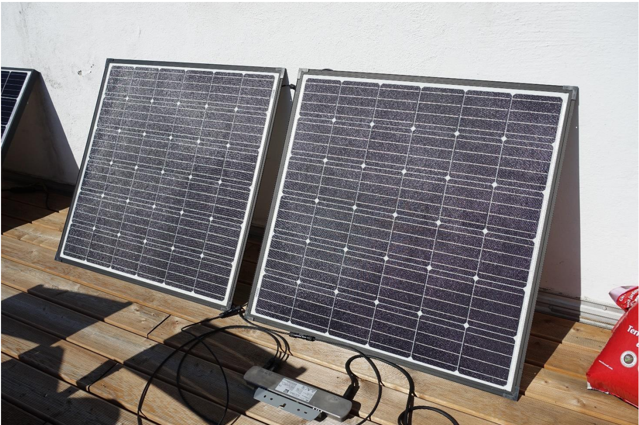
Abbildung 14: Balkonmodule. Foto: Karlsruher Energie- und Klimaschutzagentur
